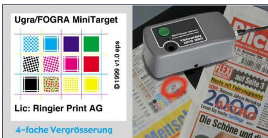
Slika prikazuje merjenje odtisa z denzitometrom
